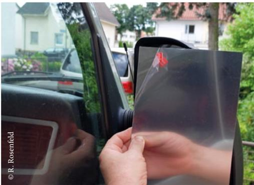
Ersatzspiegel: Zuschneiden, aufkleben, Schutzfolie entfernen, fertig!
