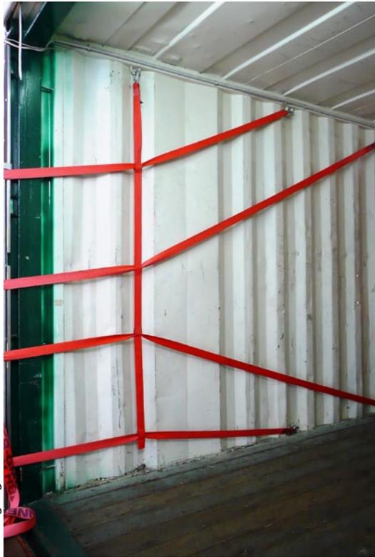
Abb. 14 Fertig installierte Lashing-Systeme
