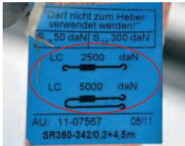
‚LC‘ (Lashing Capacity = Zurrkraft) ist die maximale Kraft in direktem Zug, der ein Zurrmittel im Gebrauch standhalten muss.
