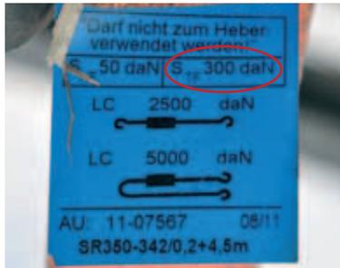
S<sub>TF</sub> (Standard Tension Force = normale (Vor-)Spannkraft) ist die Kraft, die nach dem Vorspannen des Spannelements (Ratsche) mit 50 daN Handkraft und Loslassen des Handgriffs im Zurrgurt verbleibt.
