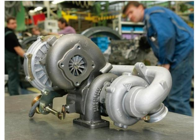
Die o.g. Systeme werden eingesetzt, um einen möglichst gleichmäßigen Leistungsverlauf über den gesamten Drehzahlbereich zu erzielen.
