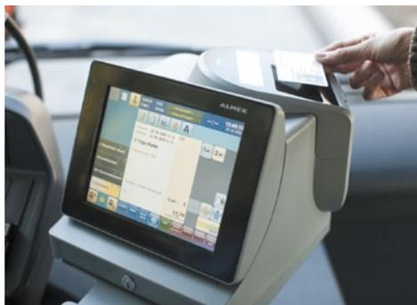
IBIS-Bedienterminal mit elektronischem Fahrscheindrucker
