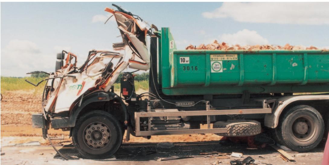
**Abb. 1.10** Dem entgegenkommenden Lkw wurde das Fahrerhaus zerstört, Quelle: DEKRA Automobil GmbH
