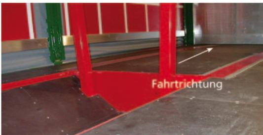
■ Abb. 6.14 Formschluss nach vorne durch Mulde und Vierkantrohre (für Stahlcoils), Quelle: Rudolf Sander
