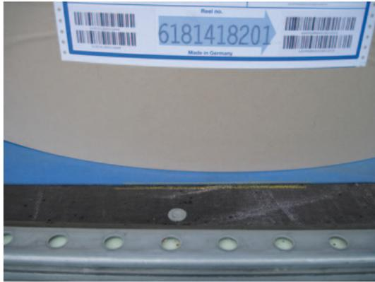
■ Abb. 6.71 Sicherung mit Antirutschmatten, Quelle: Palm
