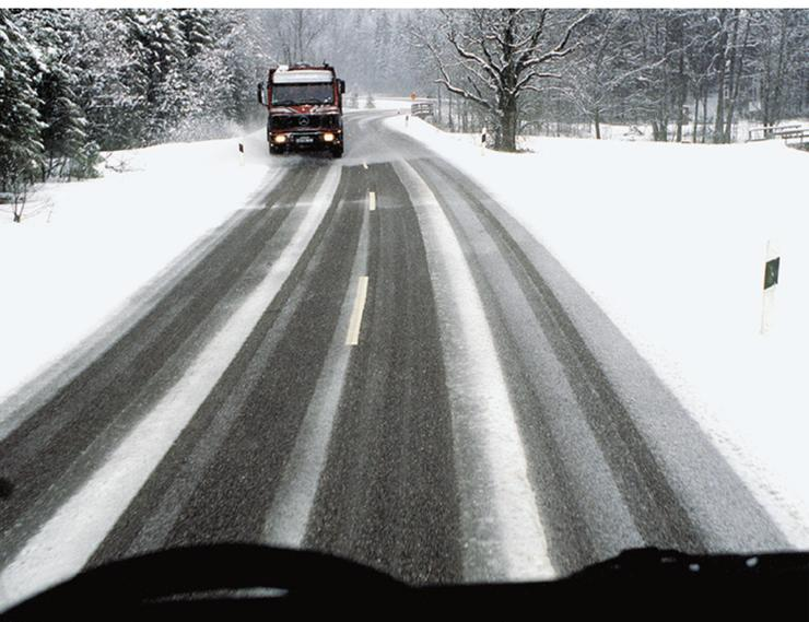
Meiden Sie das Ausweichen auf Fahrbahnrande, deren Tragfähigkeit Sie nicht abschätzen können. Die Postkarten-große Aufstandsfläche des rechten Vorderrades kann unter Umständen mit 3,5 t auf den unbefestigten Fahrbahnrand drücken.
