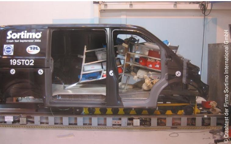
Beim Transport von Gütern treten beim Beschleunigen, beim Verzögern oder bei Ausweichbewegungen Kräfte auf, die von den Beteiligten häufig unterschätzt werden. Dabei stehen nicht solche Kräfte im Vordergrund, die bei Unfällen auftreten, sondern beim ganz „normalen“ Fahren.
