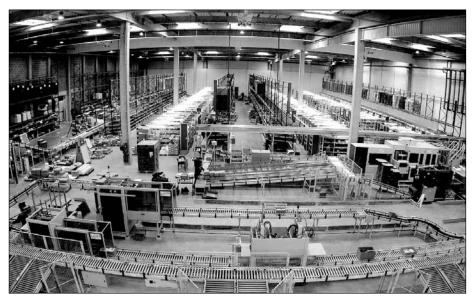
Abb. 1: Kommissioniersystem nach dem Pick-&-Pack-Prinzip
